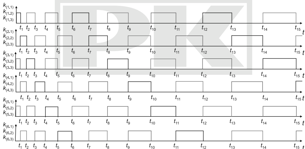
Rys. 2. Ilustracja zmiany stanów kluczy przekształtnika w stanie dynamicznym przy ciągłej zmianie częstotliwości przełączeń kluczy
