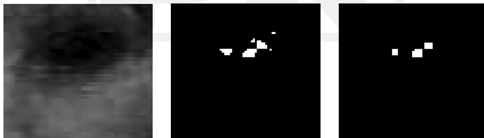
Rys. 5. Obraz oka będący różnicą składowych R i B (L), po binaryzacji (Ś) oraz po otwarciu (P)
