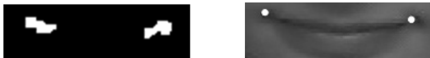
Rys. 12. Obszar ust po binaryzacji i otwarciu (L) oraz wyznaczone kąćki ust (P)
